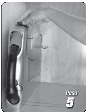
Conecte el soporte para accesorios. El soporte para cepillo se fija en la parte delantera y la pieza más pequeña se fija hacia la parte posterior.
